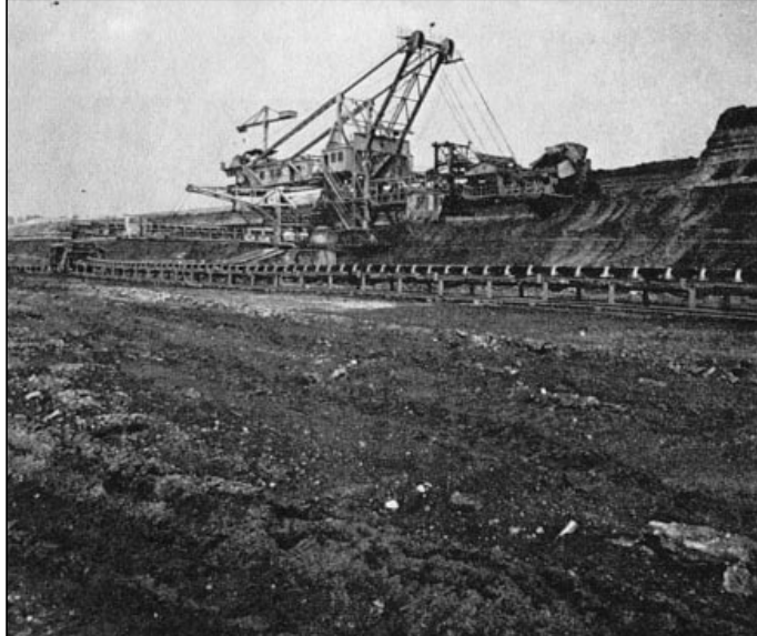
Σχήμα 3.8α. Μηχανικός εκσκαφέας με καδοφόρο τροχό, ενώ εξορύσσει λιγνίτη στο λιγνιτωρυχείο Πτολεμαΐδας. ΔΗΜΟΣΙΑ ΕΠΙΧΕΙΡΗΣΗ ΗΛΕΚΤΡΙΣΜΟΥ
